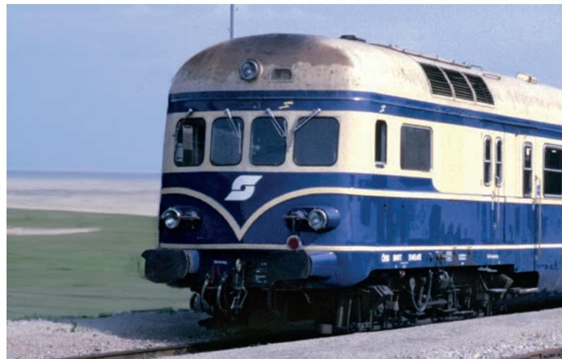
Der unter der Fabriknummer 73707 im Jahr 1952 bei SGP Simmering gebaute „Blaue Blitz“ 5045.05 wechselte im Lauf der Zeit mehrmals sein Aussehen. Per 10. Juni 1970 wurde dieser zum 5145.05 umbezeichnet und erhielt später die Dachfarbe elfenbein, unter Beibehaltung des saphirblauen Lack. Im Jahr 1990 erfolgte der Umbau auf 3 Stirnfenster und wurde in die bekannte „Papagei“-Lackierung versetzt, welche er bis zu seiner Ausmusterung - durch einen Unfall - im Jahr 1995 trug.
